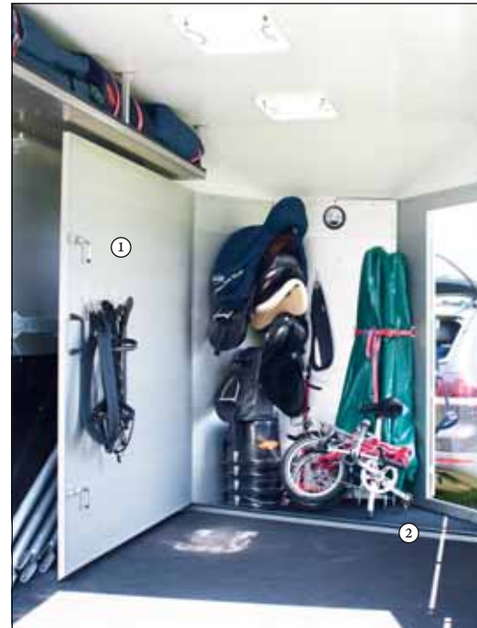
Die Sattelkammer ist durch eine schwenkbare Aluminium-Zwischenwand (1) vom Pferdeabteil getrennt. Eine Stoppleiste (2) verbindet das Eintreten von Feuchtigkeit.
