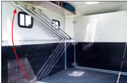
Gut verstaut: Die Teleskoptrennstangen sind dank eines Drehgelenks einfach und schnell in alle Richtungen schwenkbar und lassen sich bequem an der Seitenwand (oben) befestigen.
