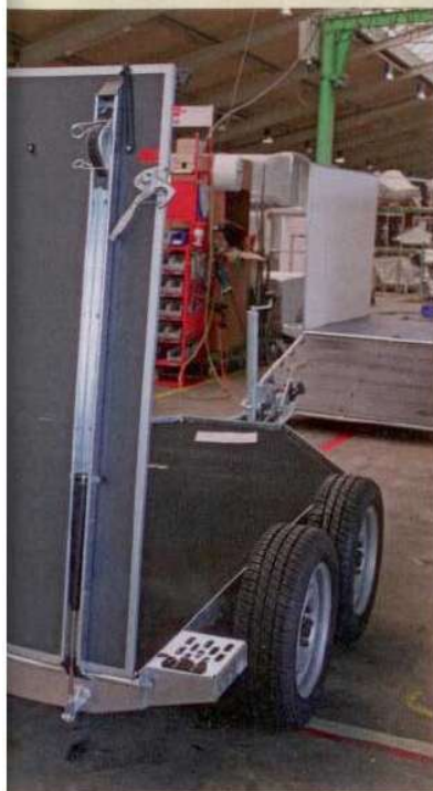
Kaum zu glauben – aber vom Aufbau wird zuerst die Verladeklappe montiert.
