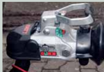
Die Kupplung besitzt einen Softstopp aus Kunststoff zum Schutz der Zugfahrzeug-Stoßstange.
